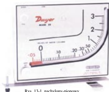
Rys. 13-1, nachylony-pionowy Manometr Mark II model nr 25. (pokazany z opcjonalnym stojakiem przenośnym A-612)
